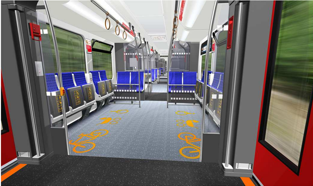
Neugestaltete Mehrzweckbereichen bei der S-Bahn Berlin
