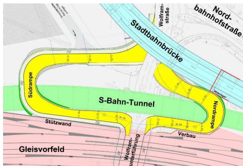
Abbildung 1: Übersicht - geplante Umfahrungsschleifen Wolframstraße
